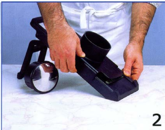
Aby zdjąć ruchomą głowicę roboczą podważ ją z boku lub zsuń przez górę.
