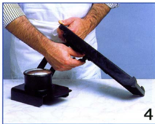
Ustaw grubość przekracając odpowiednio śrubę pod główną płaszczyzną
